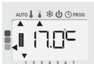
Fil pilote = Éco - 2 Confort - 2°C
